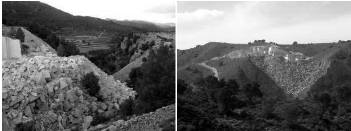
Figura 149. Escombreras de canteras de mármol que son resultado del simple apartado de los bloques del área de extracción y su vertido pendiente abajo.
