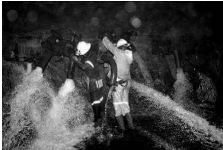
Figura 314. Drenaje de mina en frente de galería (Foto: Rafael Fernández Rubio).
