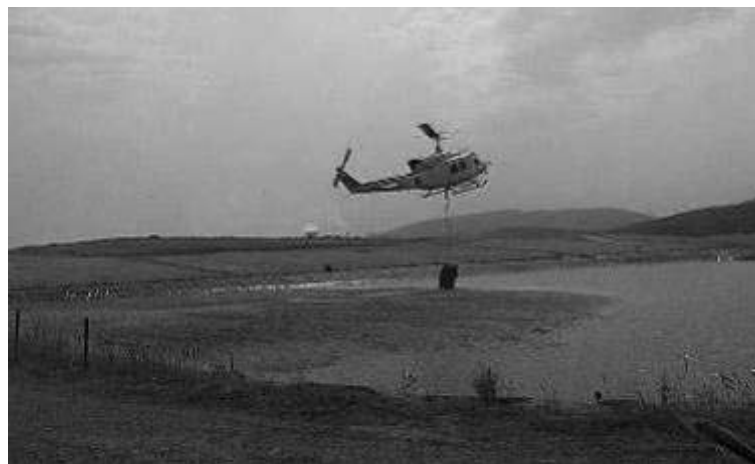
Figura 359. Helicóptero medio dotado de helibalde, en tareas de extinción forestal, cargando agua en una balsa de la explotación de la mina Emma, de Encasur-ENDESA (Puertollano, Ciudad Real).
