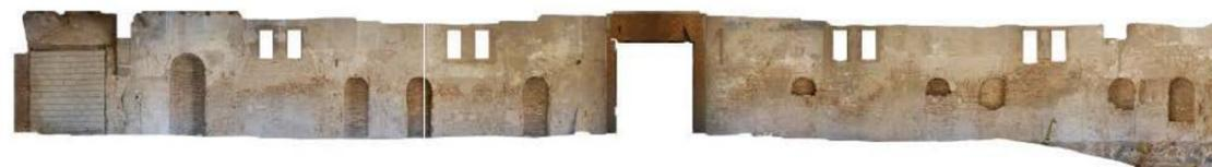
Fotogrametría planta baja. Alzado sur de la galería sur del claustro. L. Núñez Arce
